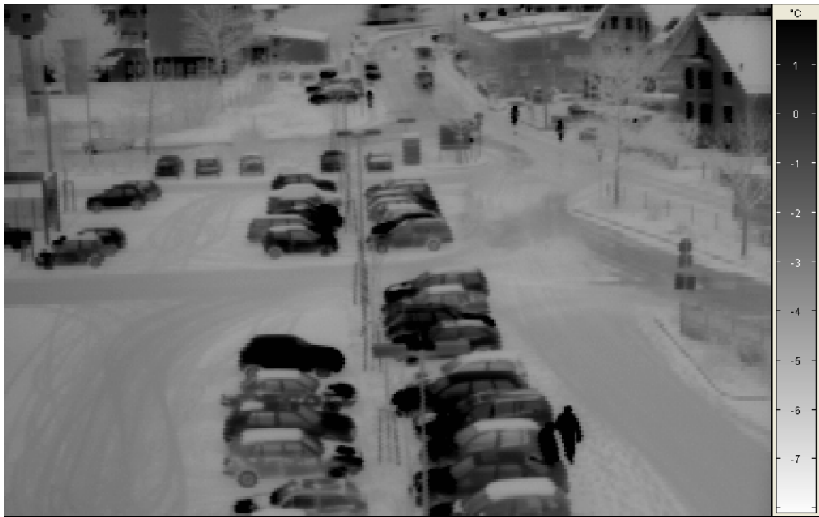
Abb. 5: Bildaufnahme im FIR (Wärmebild), Darstellung: Weiß- Schwarz-Bild
