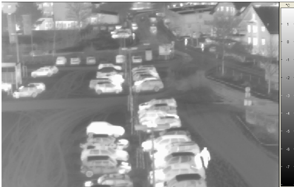
Abb. 6: Bildaufnahme im FIR (Wärmebild), Darstellung: Schwarz- Weiß-Bild
