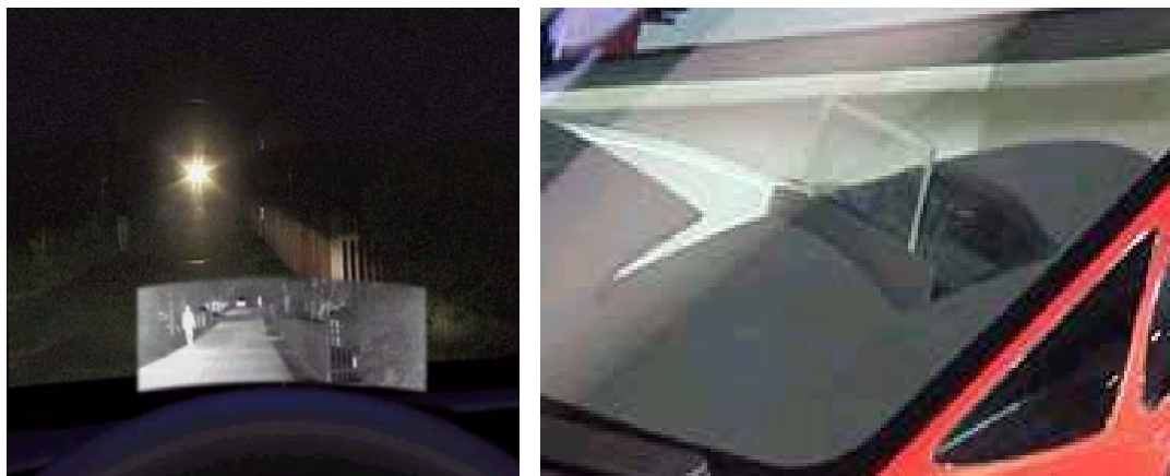
Abb. 2: Passives Nachtsichtsystem von Autoliv in einem Volvo Concept Car, [7],
